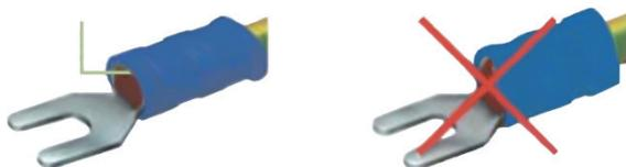
El prensado de las terminales aisladas se efectúa en forma ovalada. En las normas DIN 46245 están especificados los colores de los terminales según el diámetro del cableado.
