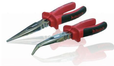
Mordazas estriadas semirredondas. Acero C-45 templado al aceite. Cortes templados por inducción, para hilos blandos y duros hasta 150 kp/mm<sup>2</sup> (1500 N).
