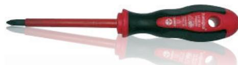
Con empuñadura de 2 componentes de PP/TPE, hoja de acero molibdeno-vanadio, templada, brillante. Todos los modelos se encuentran homologados y certificados, pasando los controles de seguridad GS/VDE 1000V.
