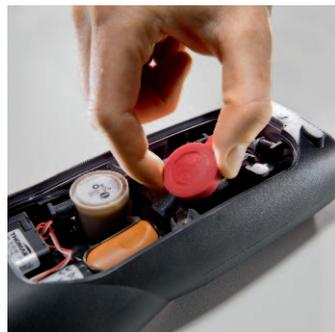
**El usuario puede reemplazar el sensor o cambiarlo por otro de otro gas en cualquier momento y lugar...**
