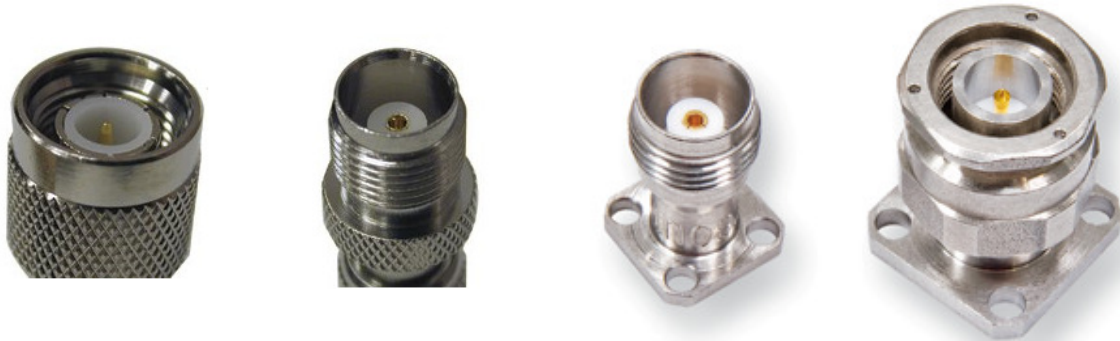
Figura 4: Conector TNC de 50 ohm – Izquierda versión ranurada / Derecha versión frecuencia extendida
