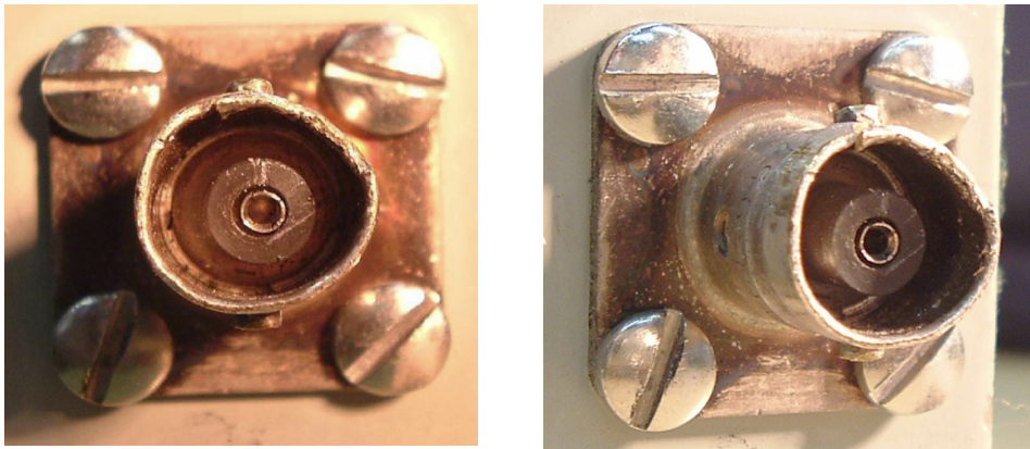
Figura 38: Conector BNC severamente dañado
